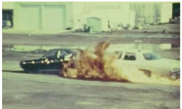
[49] 1971 Chevrolet Impala gegen 1972 Ford Pinto: Vollauffpralltest am Heck // 1971 Chevrolet Impala vs. 1972 Ford Pinto: full-rear impact
